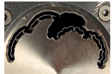
Titanrohling mit gefrästen Retainern.
